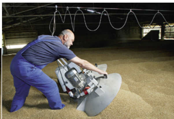
Nach dem Einschalten gräbt sich die Schnecke langsam und immer tiefer in den Stapel. Die Mischschnecke ist in Längen von 1,50 bis 4 m erhältlich. Herausnehmen lässt sie sich durch leichtes Anhebeln einfach.
