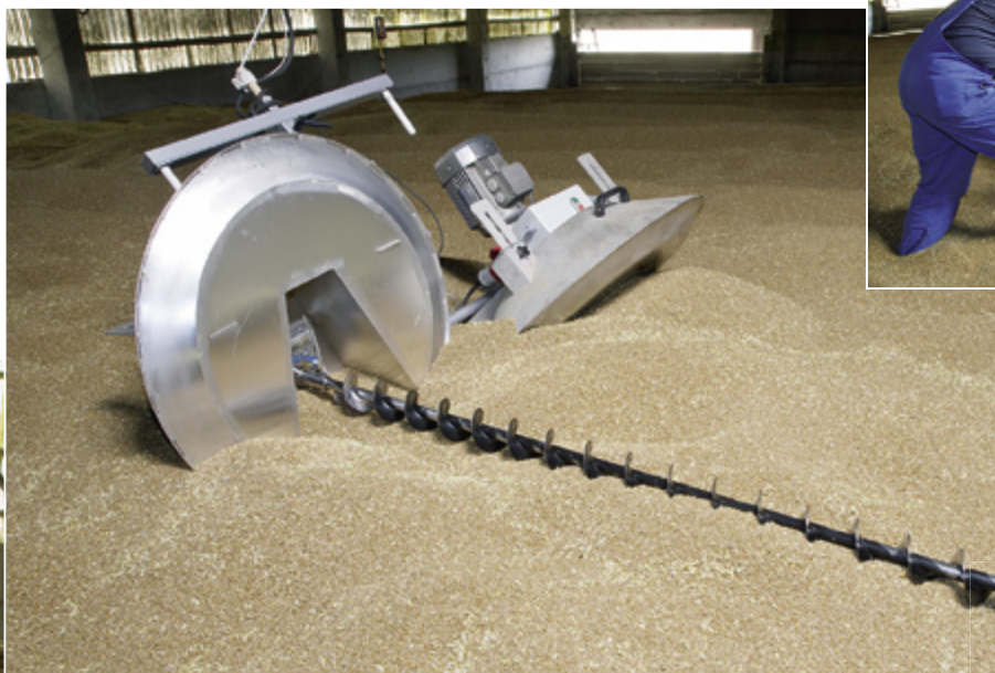
Nach dem Einschalten gräbt sich die Schnecke langsam und immer tiefer in den Stapel. Die Mischschnecke ist in Längen von 1,50 bis 4 m erhältlich. Herausnehmen lässt sie sich durch leichtes Anhebeln einfach.
